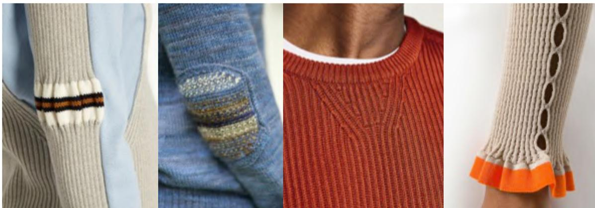
**Рисунок 63. Примеры влияния приёмов вязания на внешний вид изделия: смена переплетения, смена вида пряжи, использование фасонной пряжи, переносы петель**
